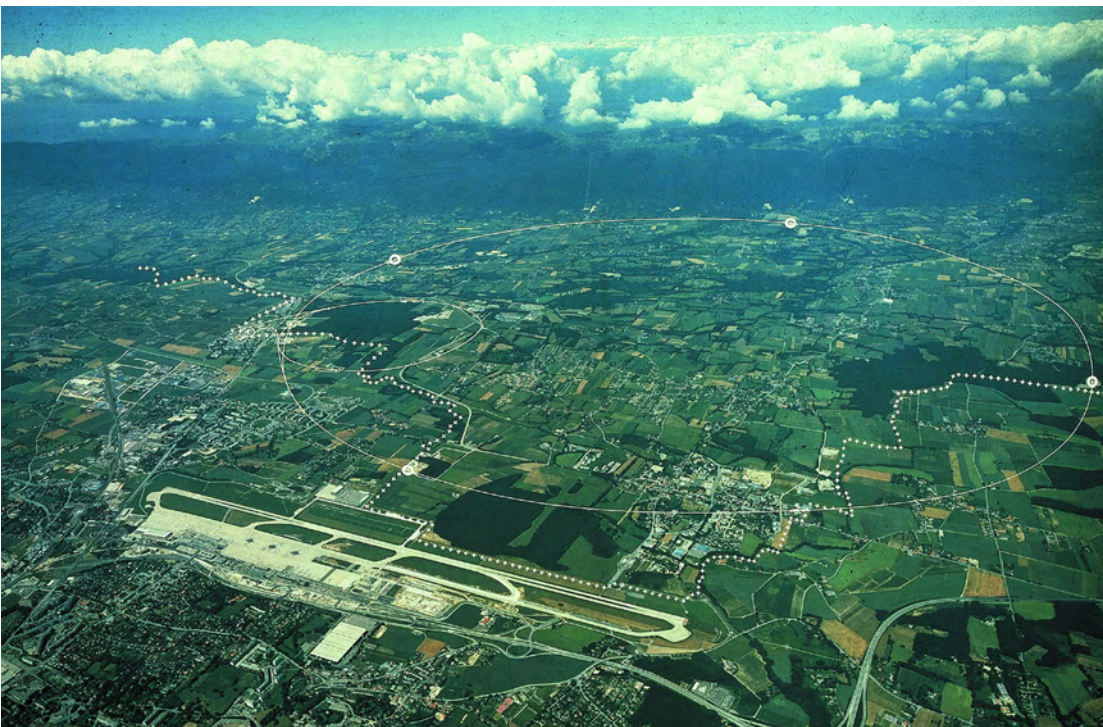
Fig.1. Fotografia aérea da região de Genebra junto à fronteira franco-suíça, onde está instalado o CERN. Os círculos brancos indicam a posição dos dois aceleradores subterrâneos: o SPS (onde foram descobertos os bósons W, em 1983) e o LEP que, com 27 km de comprimento, é o maior instrumento científico do mundo. O CERN é a área edificada junto à intersecção dos dois anéis. O aeroporto é visível em baixo à esquerda.
