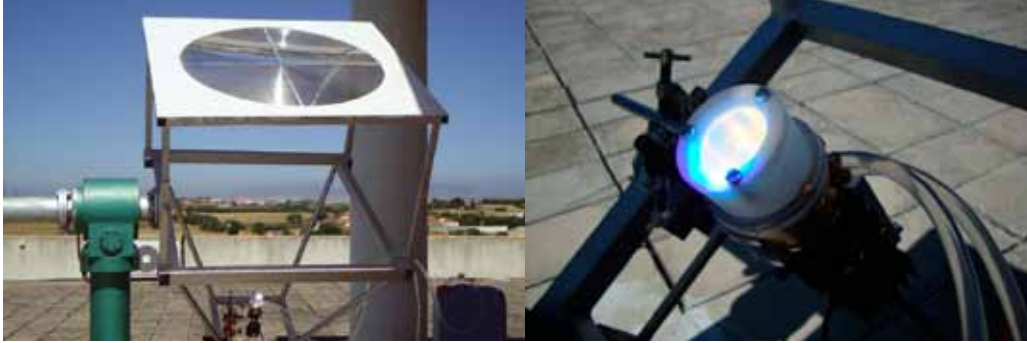
Fig. 4 - (a) Laser de 5 W com bombeamento solar através de uma lente de Fresnel de 0,5 m 2 ; (b) Detalhe da cavidade laser (FCT/UNL).
