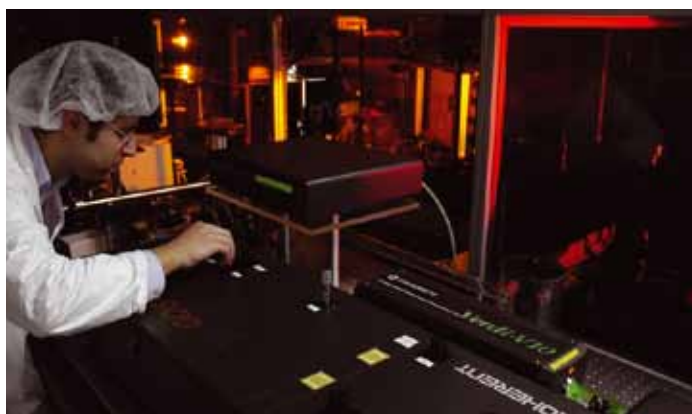
Fig. 3 - Oscilador e amplificador regenerativo do sistema laser de terawatts do Laboratório de Lasers Intensos, IST.
