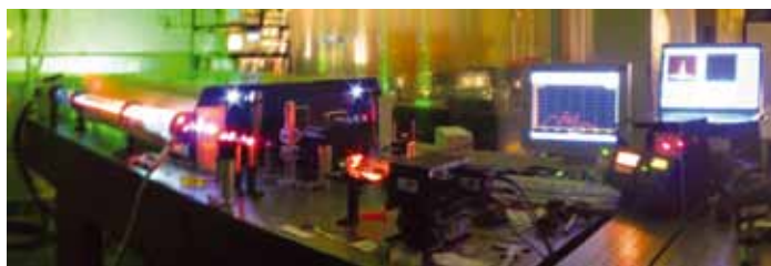
Fig. 2 - Sistema de alta energia (compressor de fibra oca)
