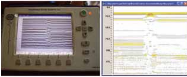
Fig. 3 - Radargramas do cilindro metálico. Esquerda: leitura em tempo real, sem qualquer tratamento; direita: depois de analisados através do software RADAN.
