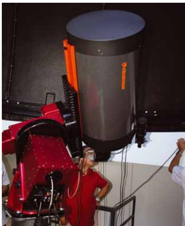
Fig. 2 - Telescópio e montagem computadorizada do Observatório Astronómico de Fronteira utilizados no projecto TRANSIT (FCT).
