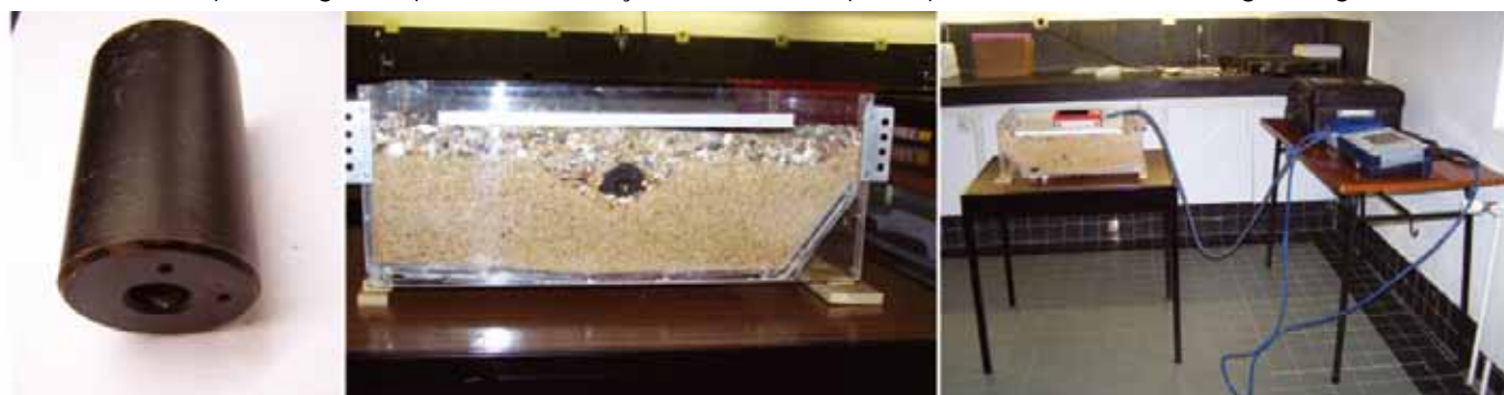
Fig. 2 - Experiência laboratorial. À esquerda: cilindro utilizado; ao centro: caixa de acrílico com cilindro metálico enterrado; à direita: panorâmica de todo o equipamento utilizado.
