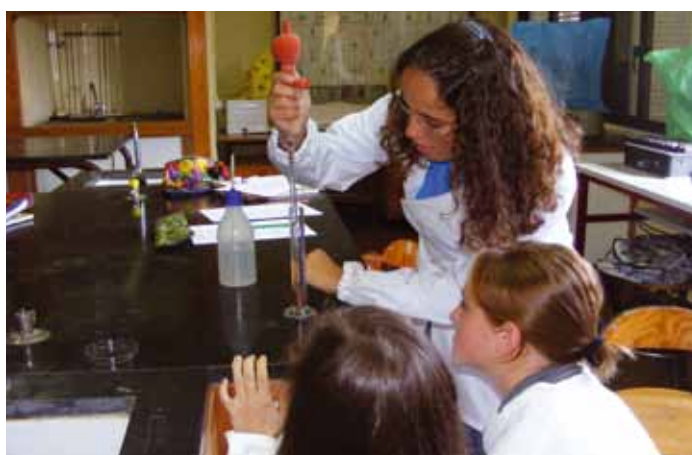
Fig. 2 - Grupo de alunas usando uma pipeta para ajustar a posição do menisco na proveta.
