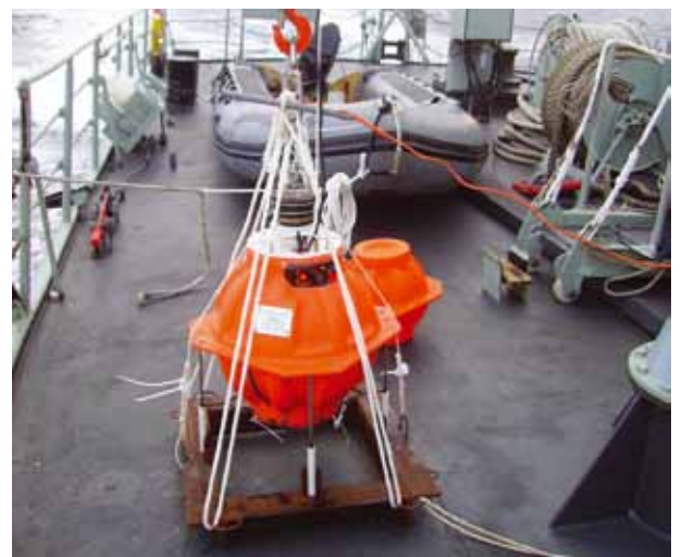
Fig. 5 - Sismógrafo submarino ( Ocean Bottom Seismograph - OBS ) desenhado e construído no IDL e utilizado em investigações no Golfo de Cádiz. Este modelo de instrumento foi utilizado nas campanhas BBMOMAR e ESPOR para o estudo da sismicidade no contacto das placas africana e europeia.
