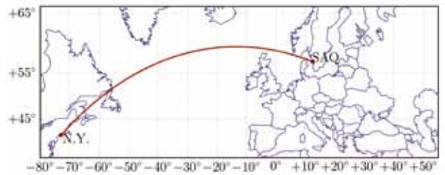
Fig. 3 - Mapa de Grimeton - Nova Iorque. Ao longo de 100 km de costa na província de Halland, a sul de Gotenburgo, um grande círculo pode ser desenhado até Nova Iorque, praticamente sem tocar terra. Este facto é extremamente importante pois a absorção da radiação que passa sobre terra é consideravelmente maior do que a que passa sobre a água salina, que é condutora de electricidade. A antiga aldeia de Grimeton está situada a 10 km da costa, evitando assim ataques pelos navios couraçados da época.
