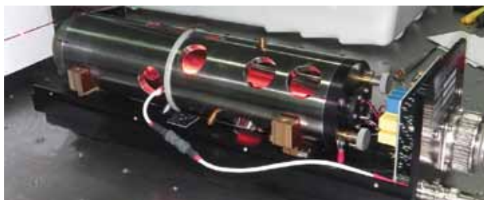
Fig. 1 - Laser-padrão IPQ3 em alinhamento e após a substituição do tubo de He-Ne. Este sistema laser é constituído por uma cavidade de ressonância formada por dois espelhos, estando um solidário com o topo do tubo laser e o outro solidário com um piezoelétrico, e por uma célula de iodo colocada no interior da cavidade de ressonância do laser. A unidade de controlo deste sistema laser permite o controlo do comprimento da cavidade e a fixação do mesmo, conseguindo-se a emissão de um feixe de luz monocromático e estabilizado de acordo com as recomendações do CIPM para a realização prática da definição do metro: f_{\text{IPQ3}} = 473\,612\,353\,601,5 kHz; \lambda_{\text{IPQ3}} = 632\,991\,212,6 fm.
