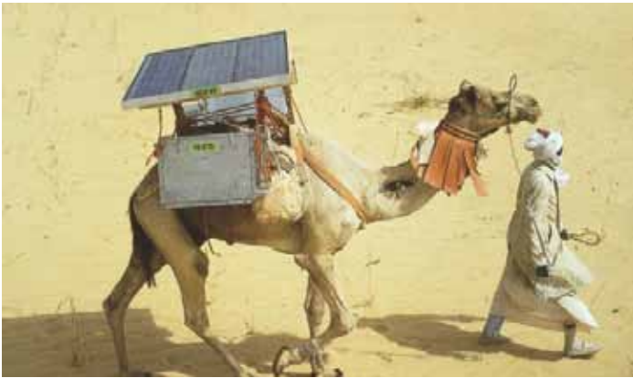
Fig. 6 - Frigorífico solar, para distribuição de vacinas.
