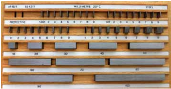
Fig. 2 - Conjunto de blocos-padrão de aço. Regra geral, os conjuntos são constituídos por 88, 111 ou 122 blocos, podendo fabricar-se outros para resposta a calibrações de equipamentos de medição específicos como é o caso do micrómetro (ISO 3611:2010) e com classes de exatidão diferentes.
