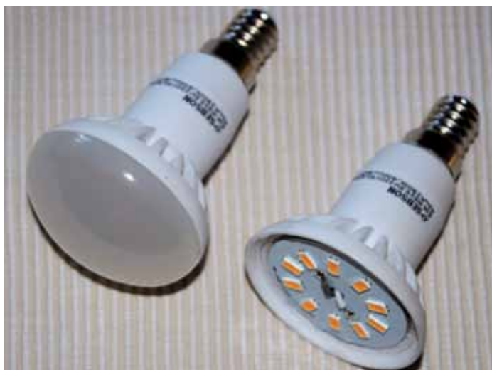
Fig. 5 - Lâmpada com casquilho E14 completa e depois de removido o difusor de luz, expondo dez LED dispostos de forma circular.
