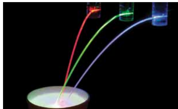
Fig. 4 - Recombinação de três feixes laser guiados por um líquido, originando luz branca.
