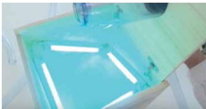
Fig. 3 - Tratamento de água com lâmpadas germicidas.
