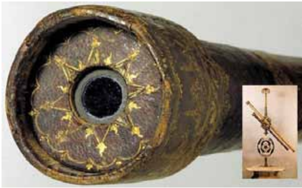
Fig. 1 - Objectiva do telescópio de Galileu e o próprio telescópio no detalhe.
