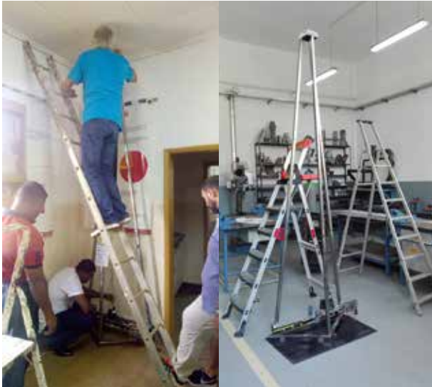
Pêndulo mundial em São Tomé: calibração (esq.) e aspeto final (dir.)
