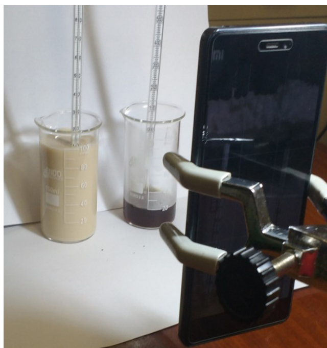
Fig. 2 - Montagem experimental onde se pode ver o smartphone usado para tirar fotografias, os dois termómetros e os dois copos com a mistura de leite e café.
