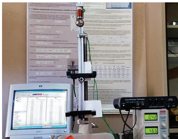
Fig. 1 - Montagem para determinação do g a partir da queda vertical de uma esfera.
