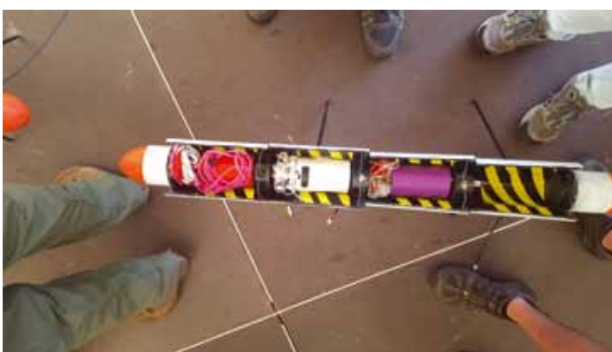
Fig. 5 - Módulo de lançamento dos microssatélites
