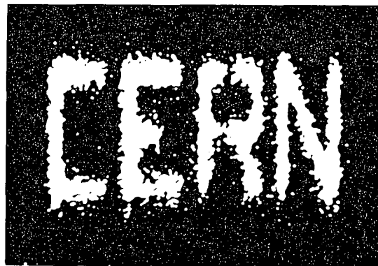
Fig. 5 — As letras têm a espessura de 50 \mu\text{m} e a altura de 1,5 mm. São produzidas por avalanches num único fio anódico. Admitia-se que a avalanche rodeava o eléctrodo uniformemente e assim não se podia obter informação bidimensional.
