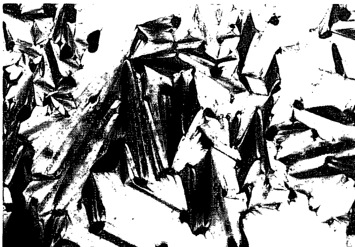
Fig. 11 — Textura em leques quebrados com cónicas focais observada, entre polarizadores cruzados, na fase S_B de um cristal líquido.
