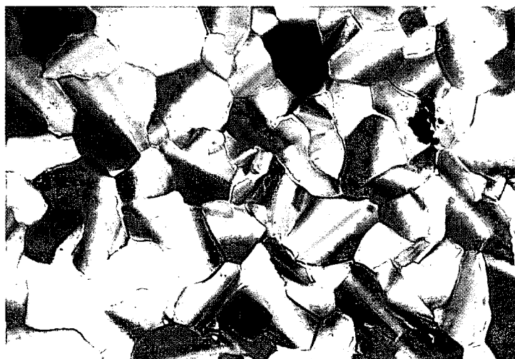
Fig. 12 — Textura em mosaicos observada, com microscópio polarizante, na fase D_{ho} de um cristal líquido.
