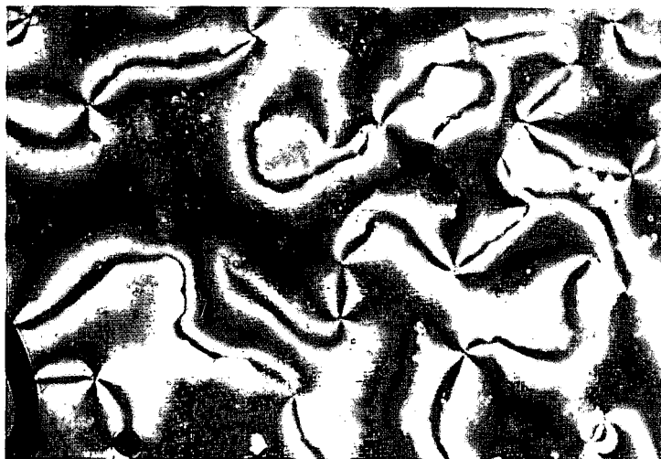
Fig. 10 — Textura nemática estriada observada ao microscópio óptico com polarizadores cruzados.
