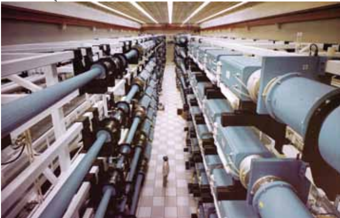
Fig. 3 - Vista da cadeia de amplificadores do sistema laser Nova (1984-1999)
