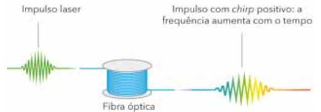
Fig. 4 - Dispersão de frequências de um impulso curto numa fibra óptica.
