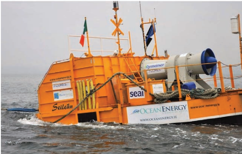
Figura 14 - Modelo de BBDB à escala 1:4 em ensaios ba baía de Galway, Irlanda, em 2011 (projecto europeu CORES). A turbine foi projectada no IST e fornecida por Portugal (fotografia disponibilizada por Kymaner Lda).
