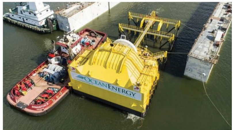
Figura 15 - Protótipo OE35 de BBDB, com potência de 1 MW. À esquerda, no estaleiro em Portland, Oregon; à direita, à saída do estaleiro, a caminho do Hawaii [4].
