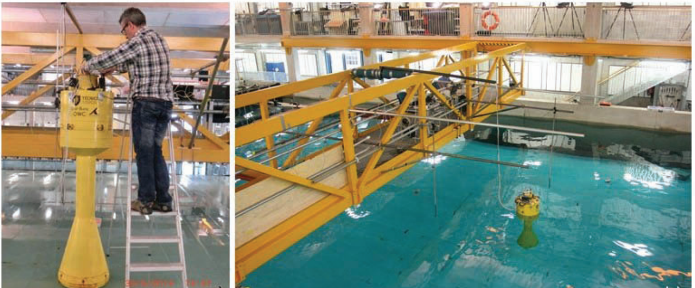
Figura 11 - Ensaio, em tanque de ondas da Universidade de Plymouth, Reino Unido, de modelo à escala 1:35 de OWC spar-buoy desenvolvida no IST (2017).
