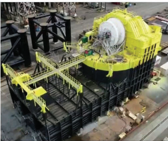
Figura 15 - Protótipo OE35 de BBDB, com potência de 1 MW. À esquerda, no estaleiro em Portland, Oregon; à direita, à saída do estaleiro, a caminho do Hawaii [4].
