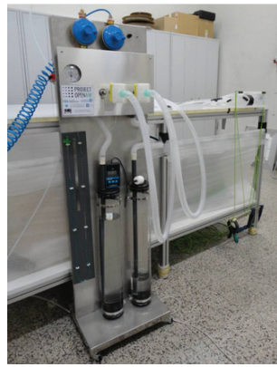
Figura 3 - Painel esquerdo: dispositivo em teste, com o sensor de oxigénio aplicado à saída de ar exalado. Painel direito: perfis de pressão medidos à entrada do tubo traqueal em função do tempo para taxas respiratórias de aproximadamente 12, 18 e 25 por minuto, razões tempo de inspiração/expiração (I/E) de 1/2 e 1/3 e complacência pulmonar de 32 mL/cmH 2 O. A PIP foi definida em 20 cmH 2 O ou 30 cmH 2 O (colunas esquerda ou direita) e a PEEP foi definida em 12 cmH 2 O em todos os casos. Foram consideradas duas fracções de O 2 exalado: 100 % ou menos de 60 %. O volume inalado correspondente, estimado a partir da calibração do "pulmão", pode ser lido na escala do lado direito.
