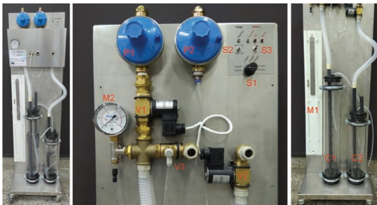
Figura 2 - Painel à esquerda: vista global do ventilador. Painel central: parte superior, com identificação dos componentes (ver Figura 1 para os componentes pneumáticos e [2] para os componentes electrónicos). Painel direito: idem, para a parte inferior. Os tubos finos nas colunas de água são para ajuste do nível e os tubos centrais podem mover-se verticalmente para ajuste rápido das pressões.
