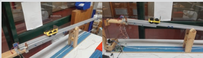
Figura 2 - Montagem experimental utilizada no e-lab. A escolha dum mecanismo de balanço permite restituir o carro à fonte de lançamento usando um ângulo negativo e facilitando deste modo a automação da experiência, onde o uso dum pala frontal permite aumentar a resistência aerodinâmica
