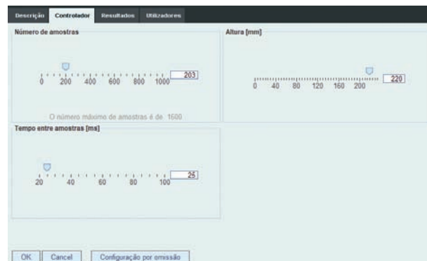
Figura 4 - Consola do e-lab (sala de controlo) que permite seleccionar a altura da calha, o número total de amostragens e o intervalo de tempo entre as mesmas.
