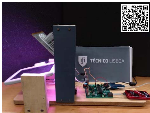
Figura 1 - Montagem experimental da experiência do painel fotovoltaico
