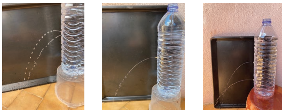
Figura 6 - a) Fontanário com dois repuxos, com os buracos feitos com a agulha quase paralela à garrafa e cabeça virada para cima ou para baixo; b) Fontanário com a água a sair por um tubinho; c) Fontanário com dois repuxos a sair por tubinhos
