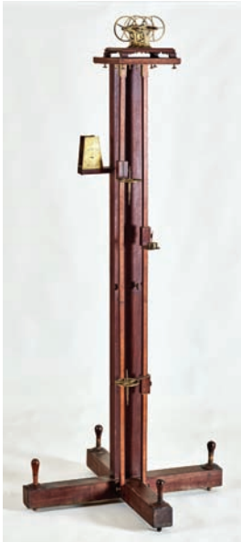
Figura 3 - Máquina de Atwood de Nairne & Blunt c. 1774 - 1793. Fotografia: Paulo Bastos © Todos os Direitos Reservados - ACL.
