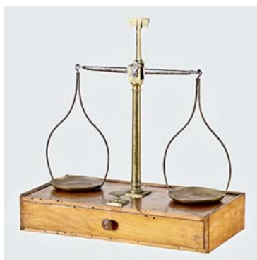
Figura 8 - Balança de pratos suspensos. Fotografia: Paulo Bastos © Todos os Direitos Reservados - ACL
