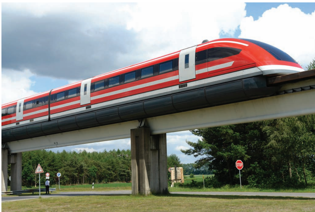
Figura 8 - O Transrapid 09 na Saxónia do Norte, Alemanha, um comboio maglev https://upload.wikimedia.org/wikipedia/commons/0/0f/Transrapid-emsland.jpg
