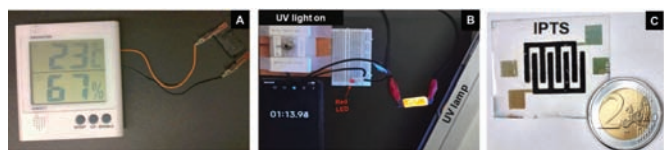
Figura 4 - (A) SC têxtil (1,5 x 4,0 cm 2 ) a alimentar um sensor digital de temperatura e humidade; (B) SC fluorescente (2,5 x 1,0 cm 2 ) exposta a uma luz UV, a alimentar um LED vermelho (com potencial de operação de 1,8 V); (C) TCSC planar preparado em PET. Adaptado das refs. 31,33 e 34 com a permissão de Springer, Elsevier e American Chemical Society, respectivamente.
