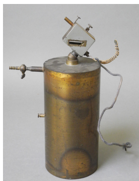
Figura 2 - Electrómetro de Wilson modificado por Francisco Nazareth, sobre uma câmara de ionização (1915). Fotografia de Gilberto Pereira.
