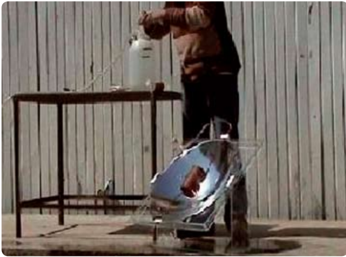
Figura 2 - Montagem do espelho com a serpentina, sistema de fluxo e recolha de água
