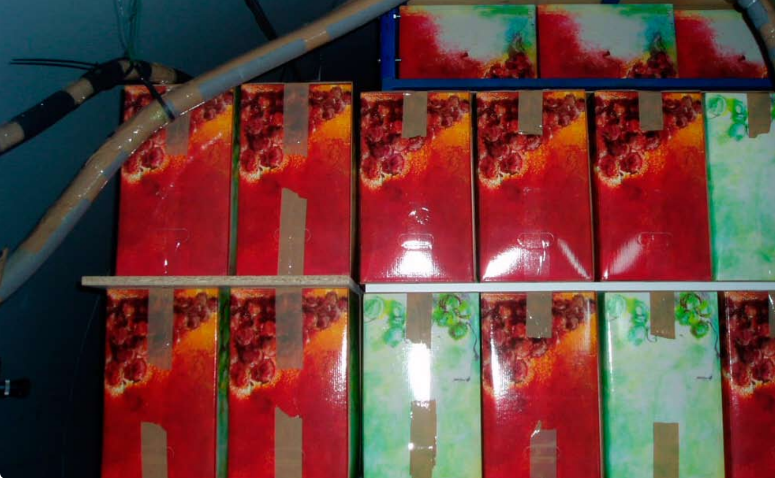
Fig. 2: (b) com a blindagem de água instalada.
