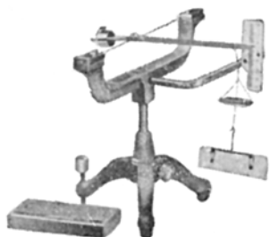
BALANÇA DE TORSÃO PARA A DETERMINAÇÃO DA TENSÃO SUPERFICIAL
