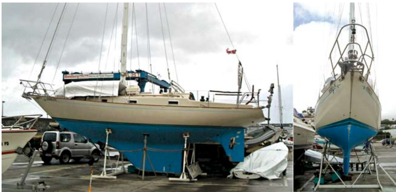
Fig. 5 - O patilhão dum veleiro, a extensão plana da quilha na base do barco, duplica a área submersa longitudinal (esquerda) mas pouco altera a área transversal (direita). Fotografias tiradas no Clube Naval de Ponta Delgada.
