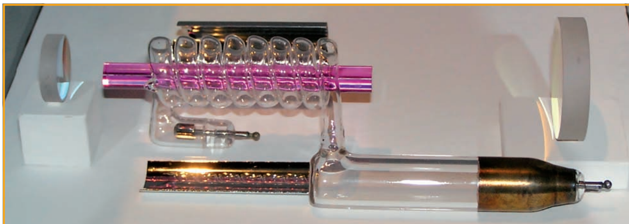
Fig. 1 - O primeiro laser em Portugal, ilustrando os componentes principais de um laser. Cortesia de J. M. Dias e GoLP/IST.
