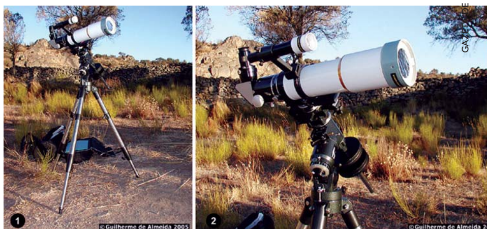
Fig. 2. Equipamento utilizado pelo autor para obter as imagens do eclipse anular deste artigo: 1- vista global; 2- tubo e montagem equatorial.
