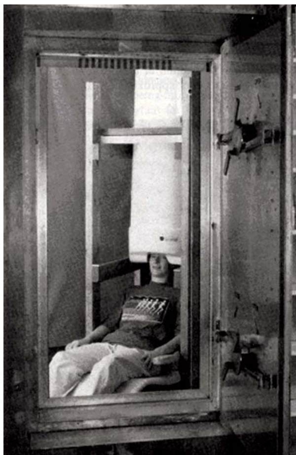
Fig. 3 - Sistema de SQUID de 122 canais, da Neuromag, colocado no interior de uma sala de blindagem magnética. (Adaptado de [5].)
