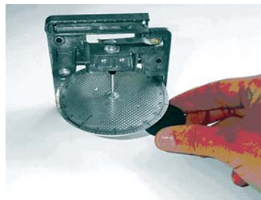
Fig. 3 - Travagem do disco, devido às correntes induzidas pelo ímã
