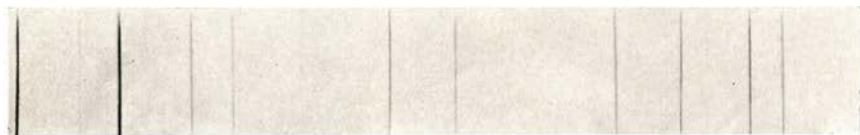
Fig. 2 — Spectrogramme des raies L du bismuth (spectre de fluorescence).
