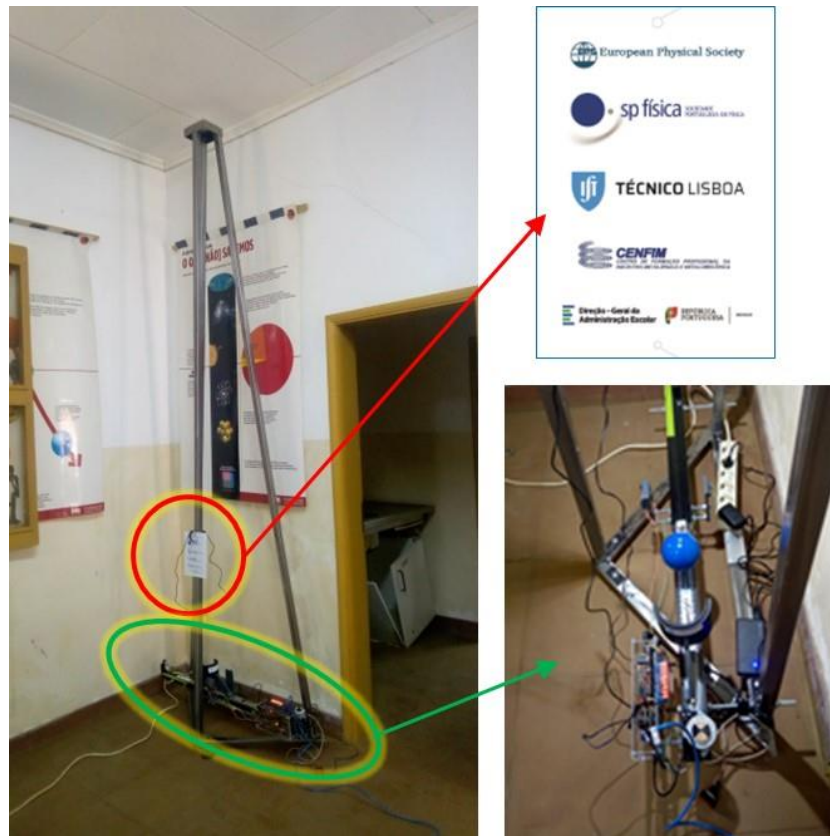
Figura 17- Fotografia do pêndulo montado na Escola Portuguesa de São Tomé, com destaque das entidades patrocinadoras e do dispositivo com aquisição de dados remota.
